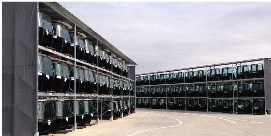
*Rayonnage galvanisé avec toit pour stockage extérieur*
