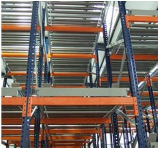
La structure est réalisée avec le rayonnage à palettes
