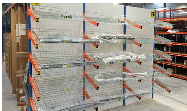
Goulottes grillagées sur rayonnage mi-lourd
