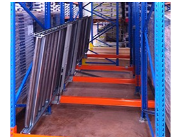
Le couloir basculant facilite l'accès au sol lors du nettoyage
