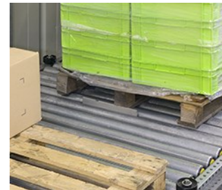
Le séparateur permet de sécuriser l'enlèvement de la première palette
