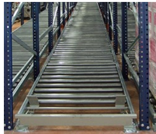
Le type de rouleaux est défini en fonction des produits à manutentionner
