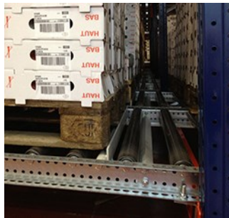
Les rails sont fixés sur le palettier
