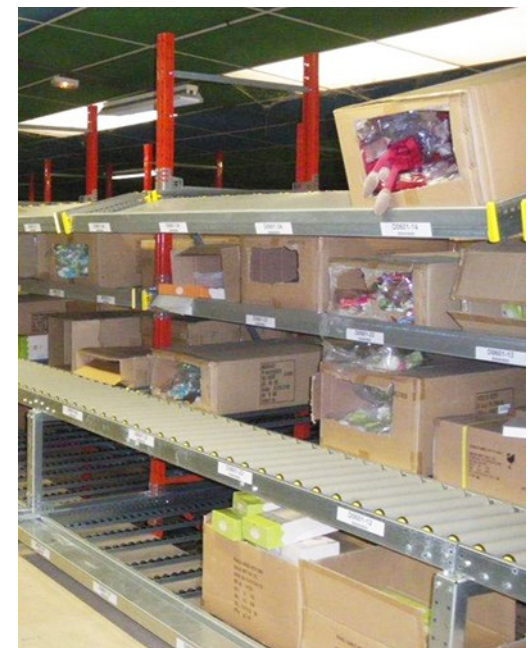
Rayonnage avec plateau de présentation qui facilite le prélèvement des unités stockées dans les cartons
