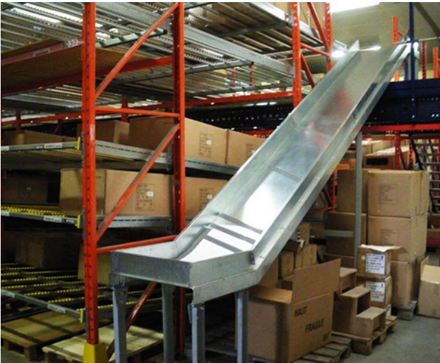
Toboggan adossé à une installation de rayonnage dynamique pour la descente des colis
