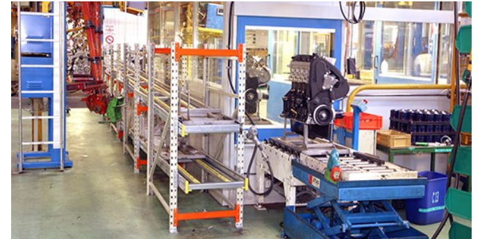
Rayonnage gravitaire de grande profondeur dans une unité de production
