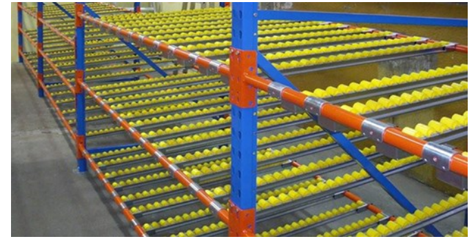
Sur des installations de petite profondeur, les rails peuvent être directement accrochés sur les longerons
