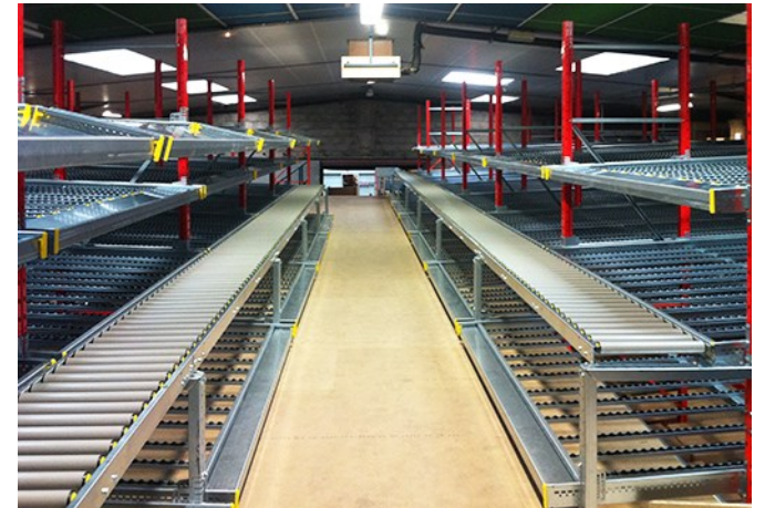
Rayonnage gravitaire de grande profondeur dans une unité de production
