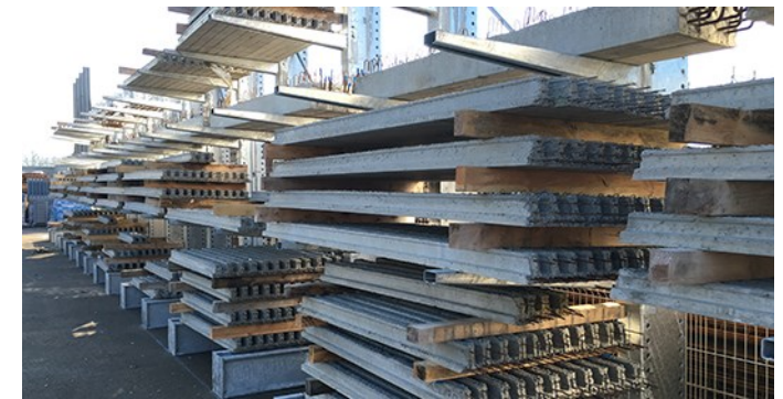
Stockage de poutrelles en béton
