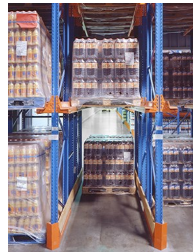
Stockage par accumulation
