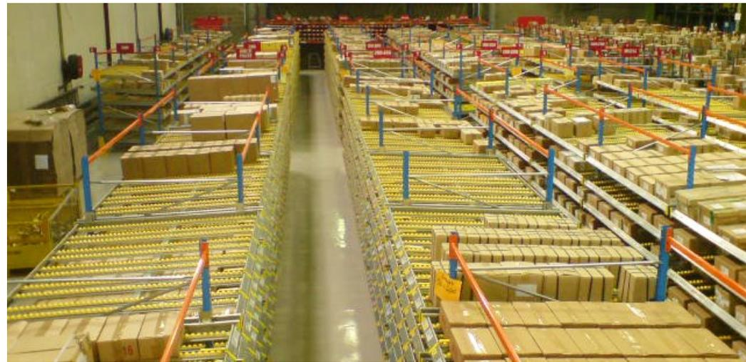
*Stockage gravitaire pour cartons dans un entrepôt pour pièces détachées de matériels agricoles*
