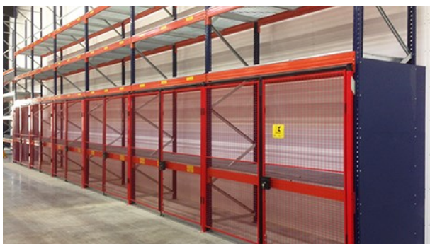
Parois d'extrémité pleines et portes grillagées
