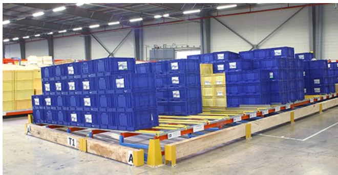
Stockage gravitaire de piles de bacs en plastique
