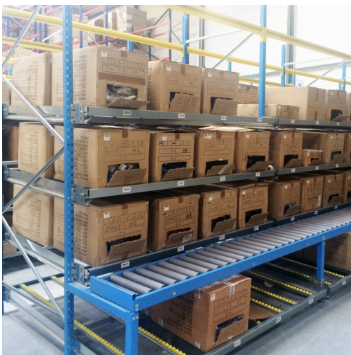
Rayonnage dynamique avec convoyeur à rouleaux libres pour le picking
