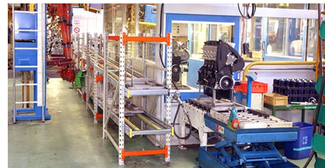
Rayonnage gravitaire de grande profondeur dans une unité de production
