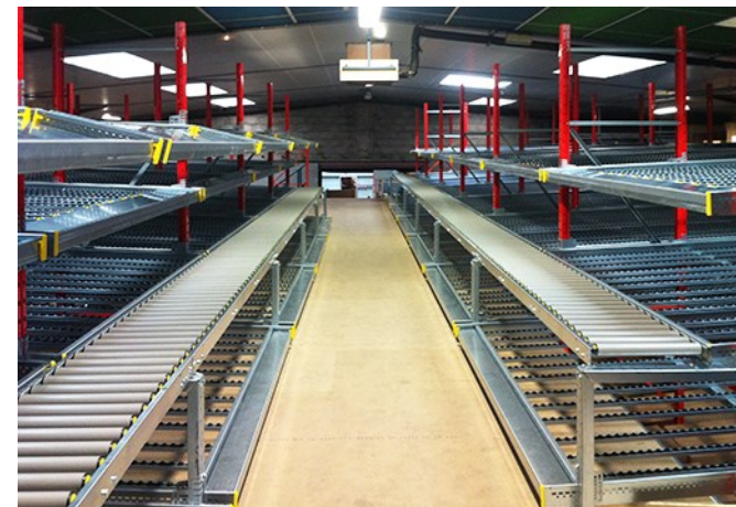
Rayonnage gravitaire de grande profondeur dans une unité de production
