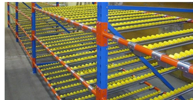
Sur des installations de petite profondeur, les rails peuvent être directement accrochés sur les longerons
