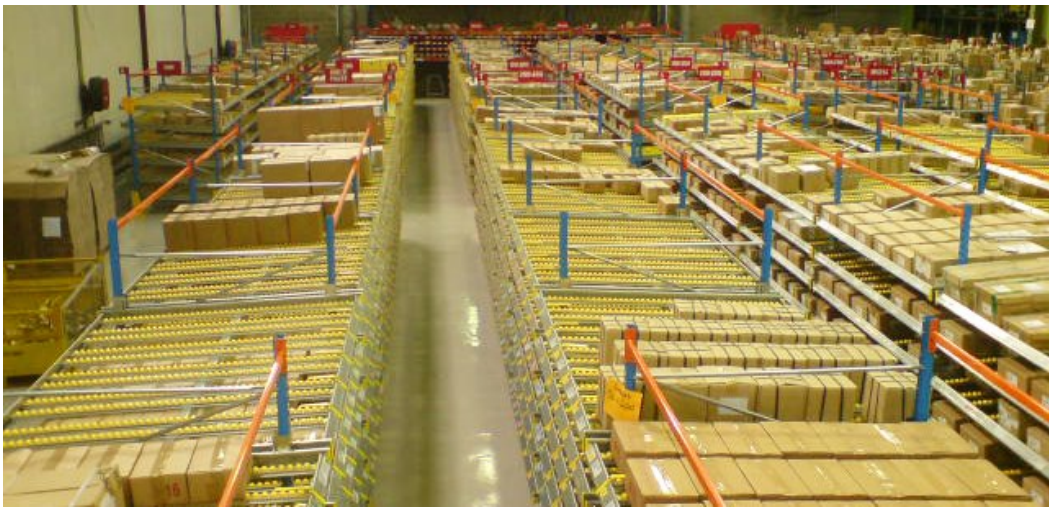
Stockage gravitaire pour cartons dans un entrepôt pour pièces détachées de matériels agricoles
