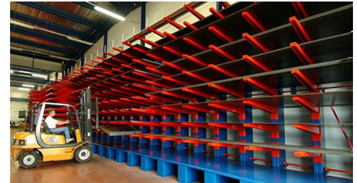
Stockage de tôles en simple face
