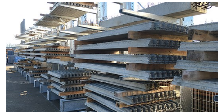
Stockage de poutrelles en béton
